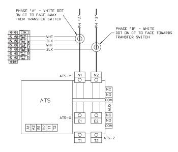
FIGURE 3. 9 - CONNECT SIGNAL WIRES (SINGLE-PHASE)
